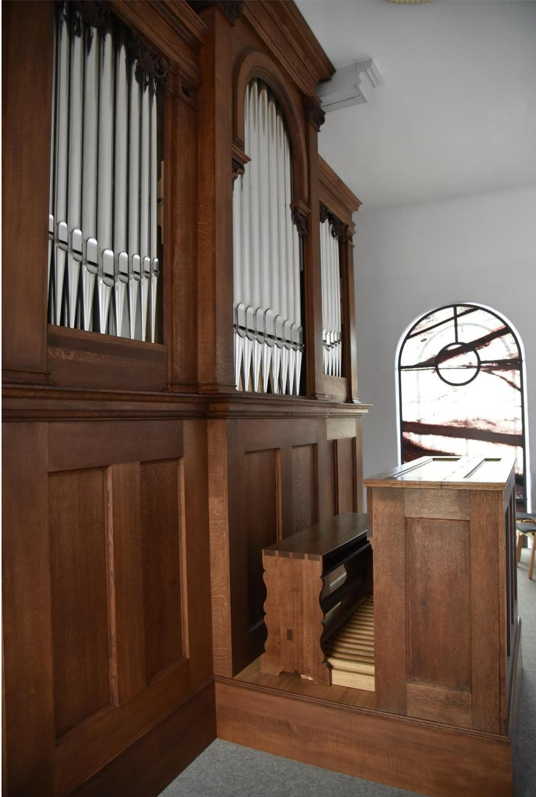
Orgelgehäuse mit Spieltisch – deutlich erkennbar sind die aufgesetzten Labien, die bei der Werkstatt Stumm von der ersten Generation an nicht nur aufgeworfen, sondern aufgesetzt waren („Häuschen“-Labien), mit den aus dem Pfeifenkörper aufgeklappten Seitenbärtchen.
