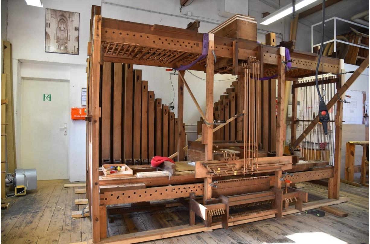
Die in der Werkstatt vormontierte Orgel – hier mit dem Manualaufbau und dem dahinter stehenden Pedalpfeifen.
